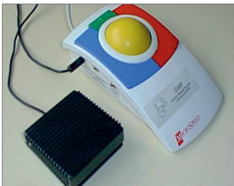
Slika 10. Alternativni oblik računalnoga miša prilagođenoga nogama za osobe s invaliditetom (preuzeto s http://www.abilityhub.com/mouse/ )
