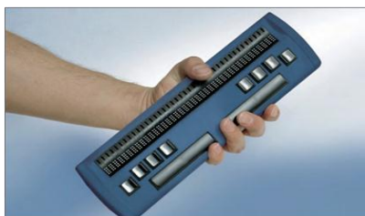
Slika 5. Brailleov redak (preuzeto s http://www.savez-slijepih.hr ) Slika 6. Prijenosno elektroničko povećalo (preuzeto s http://www.savez-slijepih.hr )
