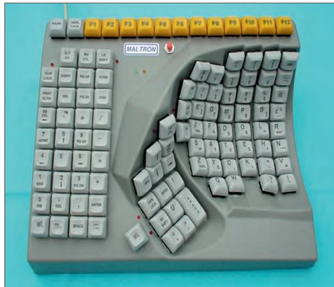
Slika 12. Alternativna računalna tipkovnica prilagođena za korištenje jednom rukom (preuzeto s http://www.spd.org.sg/programmes/assistive/atc_alternativekeyboards.html )
