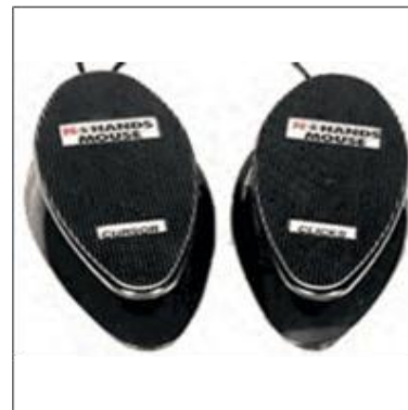
Slika 11. Računalni miš prilagođen za upravljanje (preuzeto s http://www.spd.org.sg/programmes/assistive/atc_alternativemouse.html )
